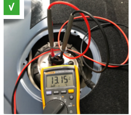
Şek. 2: Yakıt besleme modülü kapağında elektrikli geçme kontak
