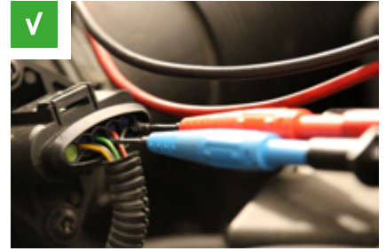
Şek. 3: Konnektörün arka tarafında ölçüm uçları
